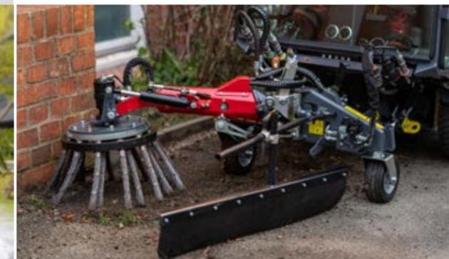
Sauber im Kehreinsatz: dank hydraulisch angetriebener 2-Besen-Kehreinheit und patentiertem Umlaufwassersystem.
