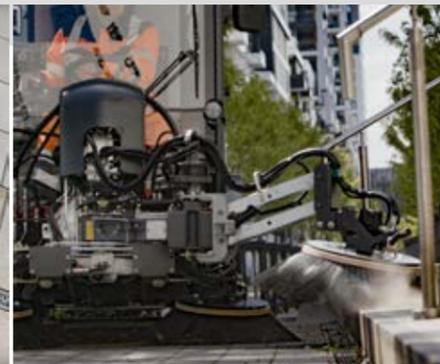
Erreicht mühelos die nächste Stufe: Mit zusätzlichem Besen können verschiedene Ebenen gleichzeitig gereinigt werden.
