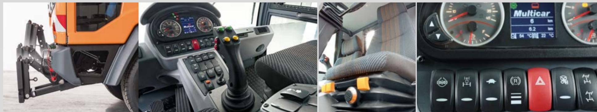
Die Basis für Multifunktionalität: das Schnellwechselsystem – zum Beispiel als Frontlift mit Geräteplatte nach DIN EN 15432-2 für Hub- und Senkfunktion zur einfachen Aufnahme von Vorbaugeräten.
