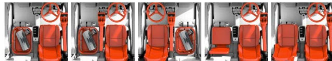
Wie für den Fahrer gemacht: Verschiedene Sitzkonfigurationen mit Komfort- oder Notsitz sowie mit oder ohne Ablagemöglichkeiten erlauben nicht nur eine variable Raumnutzung, sondern geben dem Bediener auch ein deutliches Extra an Platz in der Fahrerkabine.
